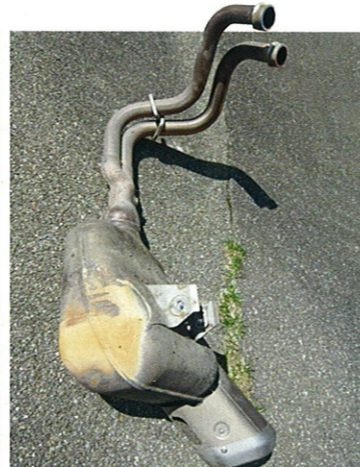
75 PS stehen auf der Einkaufsliste: Die MT-07 liefert großzügig. Ganz oder gar nicht: einteilige Auspuffanlage
